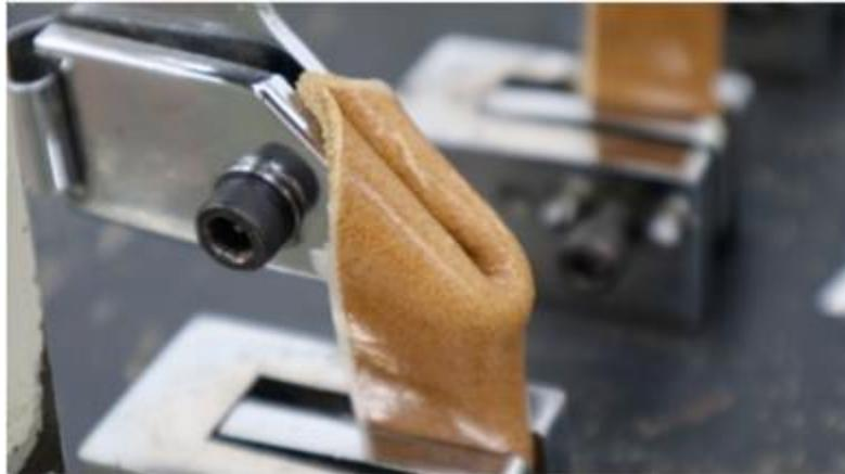
Figura 4.- Ensayo de flexion de empeine para calzado.
