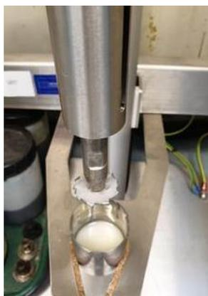
Figura 12. Mezcla Formulación 1 con el equipo Dispermat.
