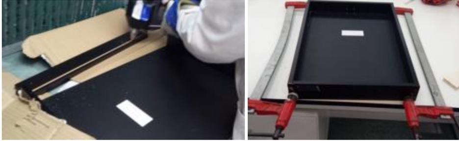
Figura 9. Aplicación del Adhesivo 6 sobre las piezas del cajón y ajuste del cajón con ayuda de sargentas.
