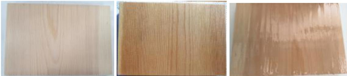
Figura 13. Madera sin recubrir (izq.), con recubrimiento comercial epoxi de referencia (central) y F8 (dcha.).
