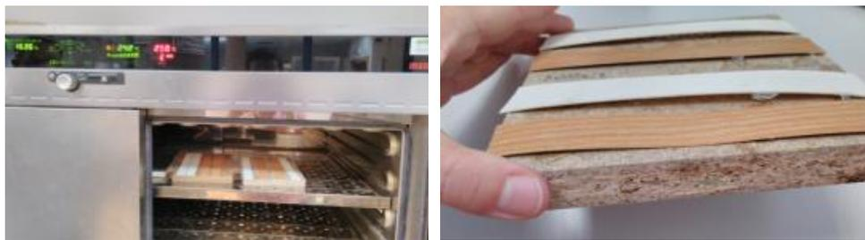
Figura 6. Tableros encolados al inicio de su evaluación frente a la temperatura (izda.) y ejemplo descolado del canto bicapa (dcha.).
